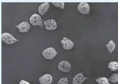
DASEA® Regencarrier® 仿生型微载体在扫描电镜下呈现多孔微球结构
